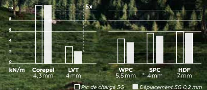
Un avantage avéré : la force exceptionnelle de Corepel a été confirmée dans le cadre d'essais de force de traction. Si deux panneaux assemblés se désolidarisent, les panneaux Corepel résistent avec une force qui est 5 x plus élevée que les panneaux possédant un noyau LVT, WPC, SPC et HDF.
