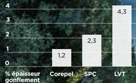
*Certifié imperméable : l'essai de gonflement des bords (ISO 24336:2005) révèle ce qui se passe avec des sols si ceux-ci sont immergés dans de l'eau. Corepel fait vraiment la différence : alors que d'autres sols prétendant être imperméables enflent en réalité, Corepel reste le meilleur choix dans ces environnements rudes.*
