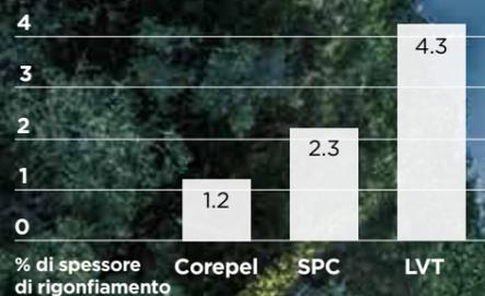
*Impermeabilità provata: il test di rigonfiamento del bordo (ISO 24336:2005) rivela cosa accade ai pavimenti quando immersi in acqua. Corepel fa la vera differenza: mentre gli altri pavimenti con caratteristiche impermeabili tendono a rigonfiarsi, i Corepel restano la scelta migliore in questi ambienti difficili.*
